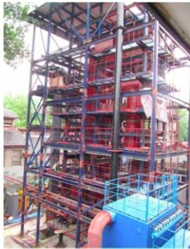
图14 2.5 MW(th)循环流化床富氧燃烧实验台
