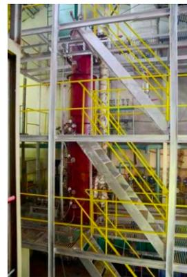
图 13 50 kW(th)循环流化床富氧燃烧实验台
